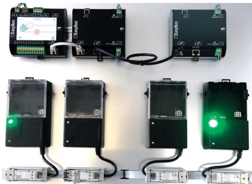
Topologie: (en haut) le module IHM à gauche peut être relié à 3 modules maîtres que l'on répartit dans le bâtiment. Chaque maître peut gérer 128 esclaves (en bas) qui disposent de 8 entrées/sorties configurables au choix. A noter, le système de câblage rapide.
